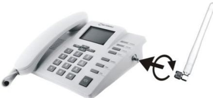
Richten Sie die Antenne am Anschluss nach oben aus. Dies stellt einen optimalen Empfang sicher.
